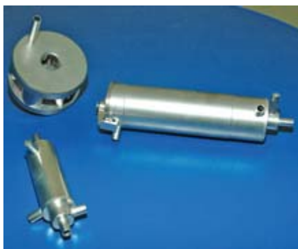
Микроканальные топливные процессоры и блоки сероочистки
