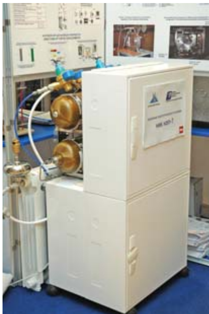
Резервная энергетическая установка «НИК НЗП - 1» мощностью 1 кВт на основе ТЭ с твердым полимерным электролитом
