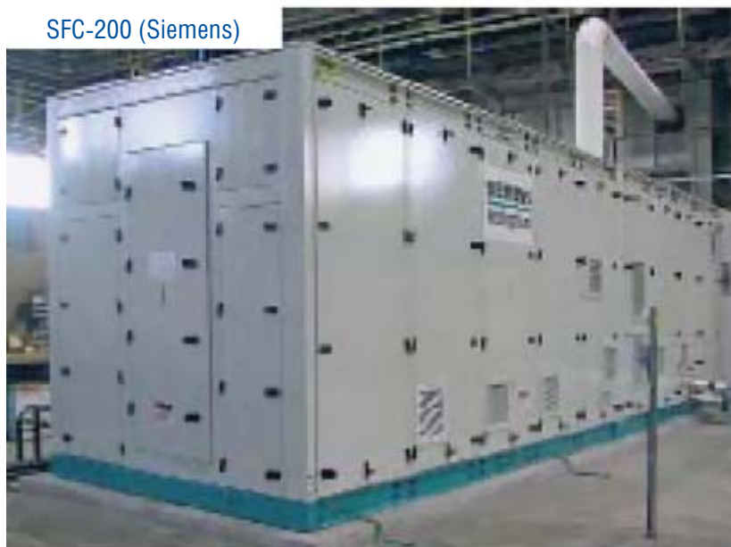
Рис. 3.25. Энергоустановки на ТЭ для систем распределительной когенерации (200 кВт)
