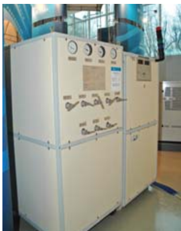
Генератор водорода (2 м 3 /ч, 10 атм)
